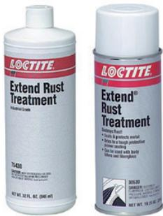
A base de ácido tánico de alta actividad, se une a los iones de hierro convirtiendo al óxido en una superficie inerte, elimina la corrosión instantánea y su componente de látex forma una película protectora contra la corrosión, listo para ser aplicada la última capa de pintura para su acabado final (no necesita capa anti-corrosiva ni imprimante). La mejor alternativa al arenado para la preparación de superficies metálicas ferrosas.
